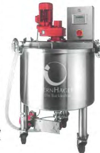
Der „Biomat 300 Ecoline“ von Isernhäger ist für die prozessgesteuerte Herstellung von einstufigem Tagessauerteig konzipiert.
