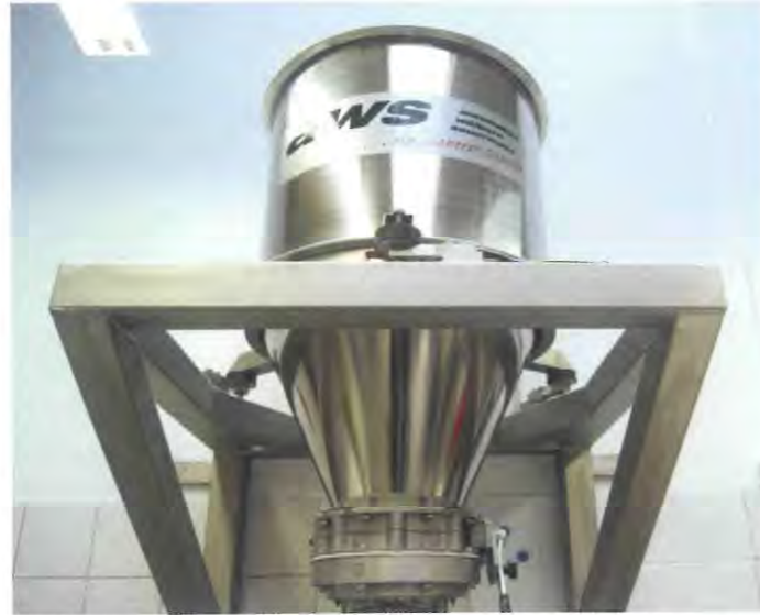
Die Silo-Mehlwaage von aws Automation verfügt über eine besonders genaue Drei-Punkt-Verwiegung.
