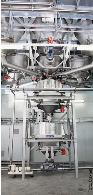
Exakte Dosierung der Chargenkomponenten durch Dosierschnecken in die Behälterwaagen und pneumatische Zuführung in den Dissolver-Mischer
