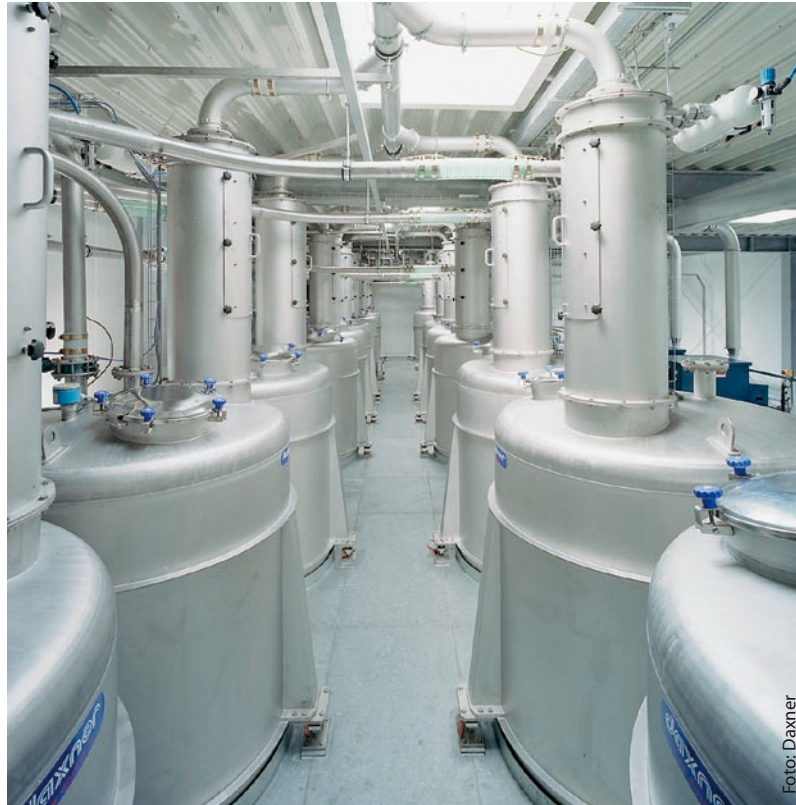
Tagesbehälter zur Vorlage von Komponenten wie Milchpulver, Kakaopulver, Zucker etc. werden pneumatisch, unter Verwendung von gekühlter und getrockneter Förderluft beschickt.
