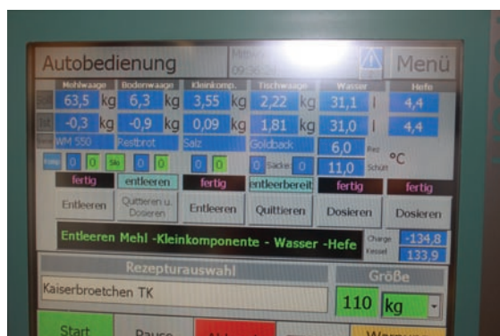
Zentrale Steuerung: Am Touchscreen von Daxner erfolgt die Verwiegung per Aufruf des Rezepts vollautomatisch.
