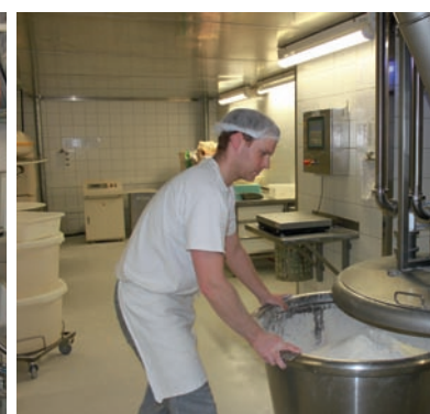
Staubfrei und exakt dosiert gelangen die Zutaten in den Knetkessel.
