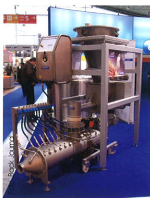
Der Anteiger von Daxner wurde konstruiert um feste Vorteiige kontinuierlich zu bereiten.
